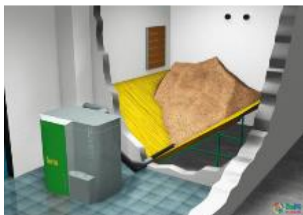
Pièce de réserve avec alimentation par vis
