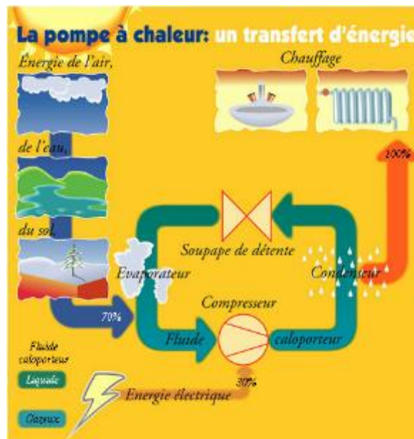
Figure 27 : principe de fonctionnement des pompes à chaleur (source www.airclim-concept.com )
