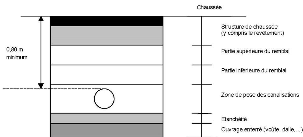
Les contraintes spéciales relatives à l'implantation d'un réseau enterré neuf à proximité d'un réseau existant, en agglomération et hors agglomération lors des travaux d'ouverture de fouilles, de remblayage et de réfection nécessités par la mise en place ou l'entretien de réseaux, devront être traitées en respectant les exigences imposées par la norme en vigueur et DTU.
